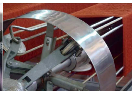
NOMEX-PTFE Hochbauschriemen in einer Textilveredlungsanlage
