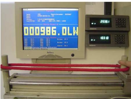
Computergestützte **Längenmessungen** von 172 mm LI – 9090 mm LI verwenden wir sowohl in der Endkontrolle wie auch bei 100%-Prüfungen, wobei im Messprotokoll sowohl die LI- wie auch die LW-Längen und die statistische Verteilung angegeben werden.
