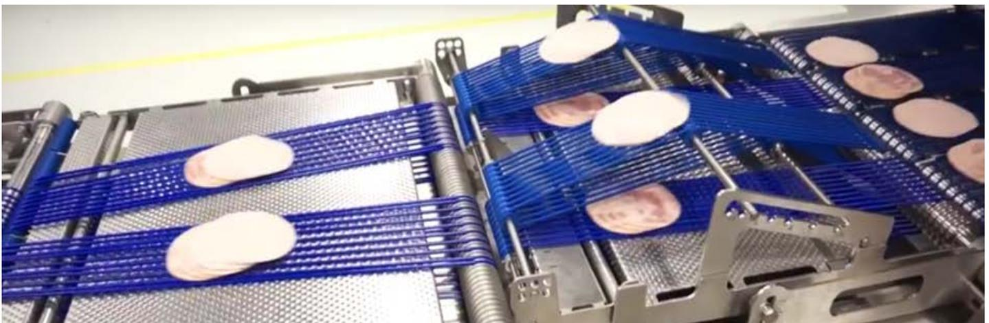
**Overlapper für Aufschnitt mit verschiedenen Rundriementypen**
