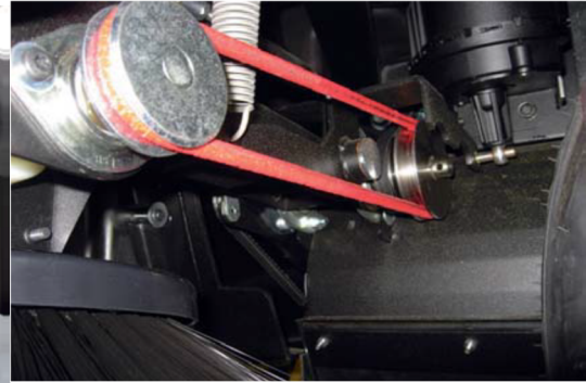
Seitenbesenantrieb einer Kehrmaschine
