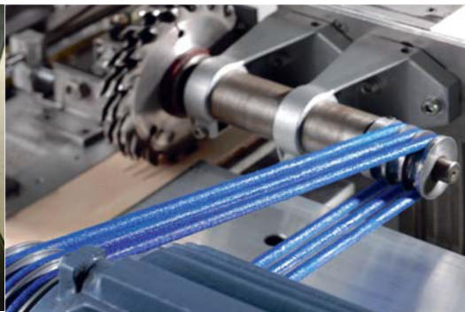
Endlos elastischer Rundriemen, PU blau in einer Holzbearbeitungsmaschine
