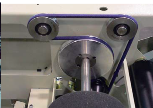
Walzenantrieb in einer Wäschefaltmaschine
