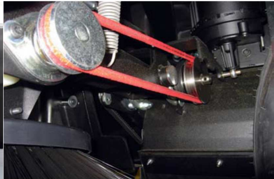
Boczny napęd szczotki w zmiatarce mechanicznej
