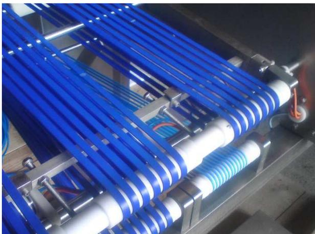
Gerne fertigen wir auch Sonderprofile für Sie, wie hier ein T-Profil 10x6 mm. Mit einem Keil 4x4 mm, der auf einer bestehenden Anlage in ein Scheibenprofil, das für Rundriemen 4 mm Ø ausgelegt war, eingebaut wurde.
