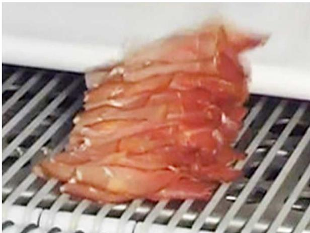
Besonders hygienisch da leicht zu reinigen, auch bei stark anhaftenden Rückständen wie Ölen und tierischen Fetten. Durch ihre ausgezeichnete Hydrolysebeständigkeit besonders für Einsätze im Nassbereich geeignet.
