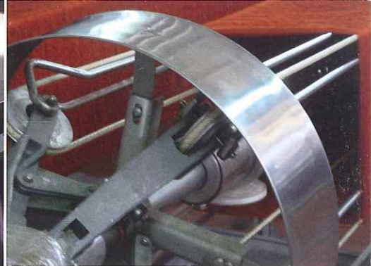
NOMEX-PTFE Hochbauschriemen in einer Textilveredlungsanlage
