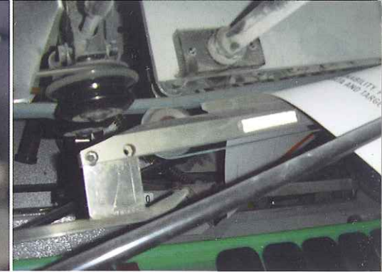
2 mm Polyester-Rundriemen in einer Falzmaschine für Papier
