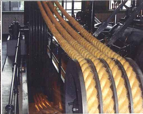
50 mm Transmissionsseile um 1910 aus Langhanf
