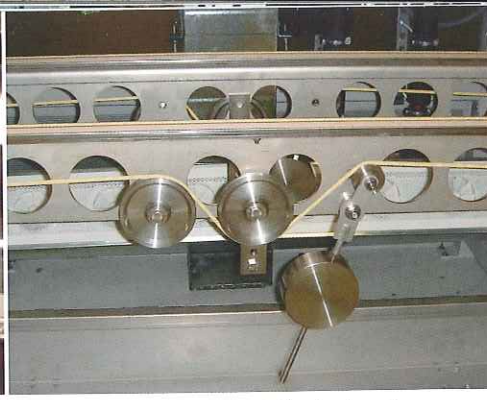
Gedrehte Rundriemen aus Keflar in einer Transportstrecke für Abdeckrahmen
