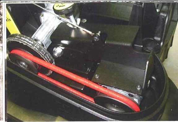
Endlos elastischer Rundriemen, PU rot im Motorraum einer Gebäudereinigungsmaschine
