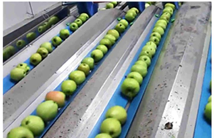
Längsgerillte Keilleistengurte beim Transport von Kirschen und Äpfeln von der Wascheinheit zur Größensortierung.
